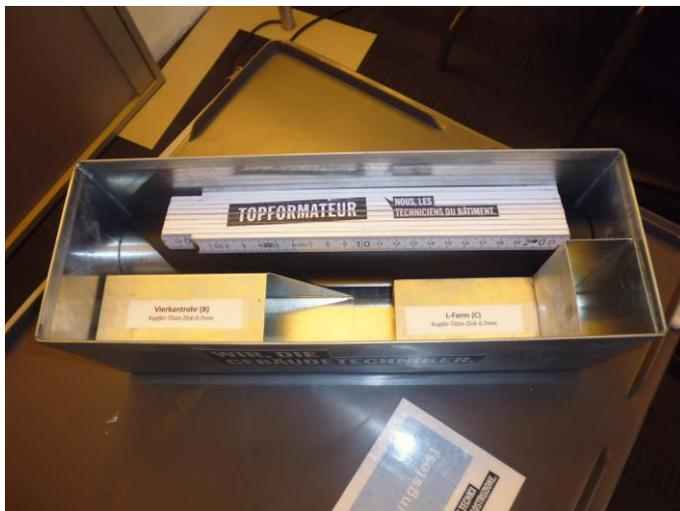
Zurzeit laufen die Pilotversuche mit dem neuen Eignungstest. Dieser wird im nächsten Jahr eingeführt und hat die abgebildete Kiste mit Rohren, Kanälchen etc. im Zentrum. Mit dem Doppelmeter messen die potentiellen Lernenden diese Bauteile aus und machen verschiedene Berechnungen. Weitere Rechnungen runden den mathematischen Teil ab. Die deutsche Sprache wird anhand eines Zeitungsartikel geprüft. Als Abschluss müssen die potentiellen Lernenden einen kurzen Aufsatz schreiben.
