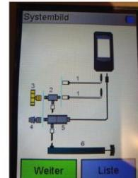
3. Danach steckte ich die Pumpe und den Schlauch zusammen. Jetzt ist alles Betriebsbereit, ich wählte im Menü Wasserleitung, anschliessend musste ich das Volumen der Leitung angeben in meinem Fall weniger als 11. Mit der Handpumpe pumpte ich bis 151 mbar, dann startete ich den Test.
