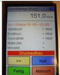
4. Anhand des Diagrammes kann man die Druckprobe genauestens verfolgen. Ich wartete 25 Minuten lang. Der Druckabfall war niedrig somit ist die Druckprüfung positiv ausgefallen.
